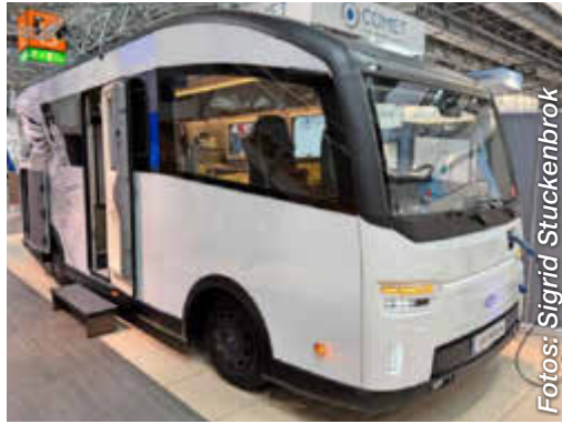
Studie EVOLVE-Skateboard-Plattform mit Niederfler-Aufbau. Die Antriebsbatterie wird zum Energie-Hub für Wohnen und Arbeiten.
